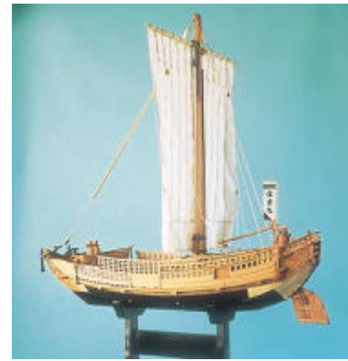
菱垣廻船（出展；玉島歴史民俗海洋資料館 HP） 和船は厚手の板を張り、船体を作る。大きな木に恵まれれば、船を経済的に作れるが、大きな船には向かない。
